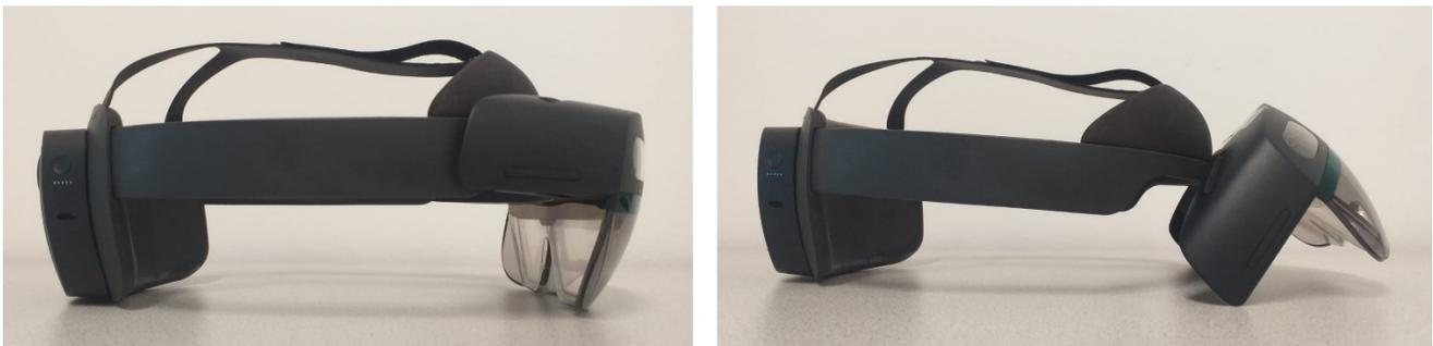
**Abbildung 2: Visier korrekt heruntergeklappt (links), Visier hochgeklappt (rechts)**
