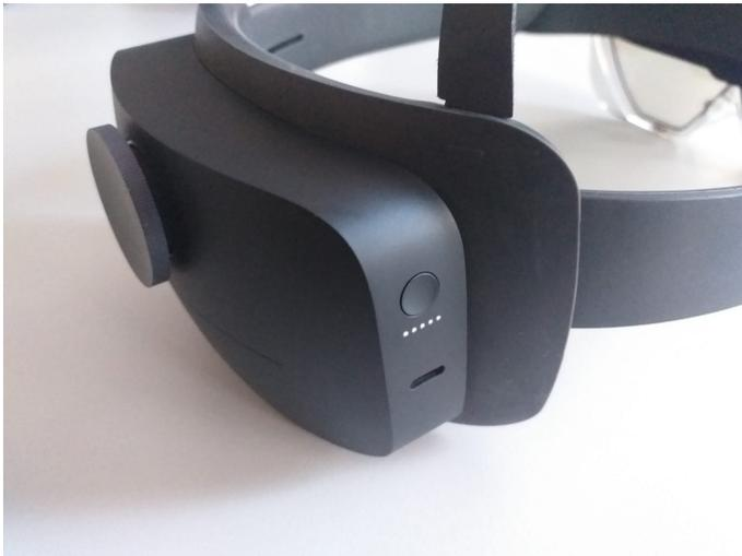
**Abbildung 1: Ein-/Ausschaltknopf, darunter Ladeanzeige und Ladestecker, links Einstellrad**
